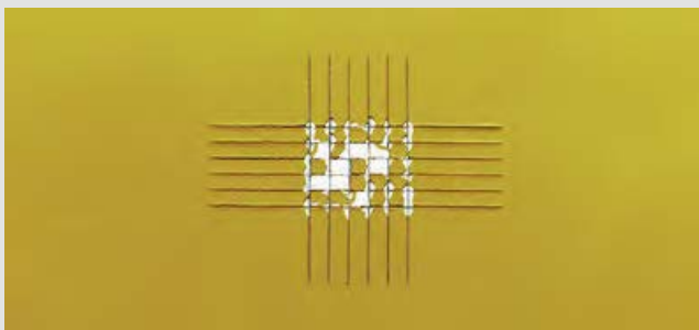
ISO等级：4 / ASTM等级：1B 切口边缘大片剥落和/或一些方格部分或全部剥落。其面积大于30%，但不足65%
